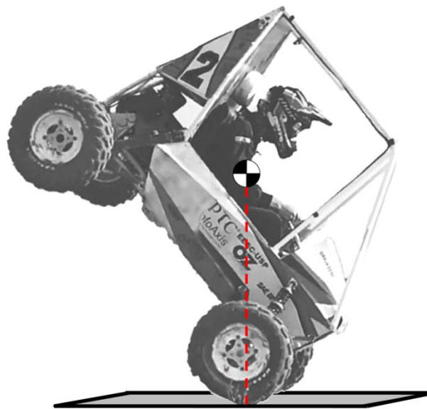
Figura 1: Condição de queda do veículo com duas rodas tocando o solo simultaneamente. Características de um veículo apenas para ilustração.
