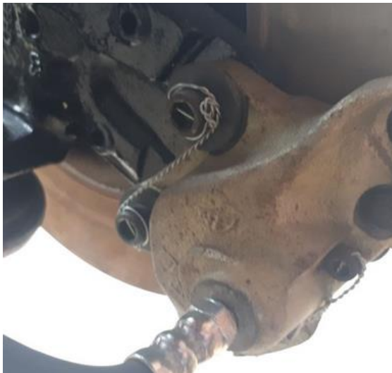
Correta fixação da pinça de freio
