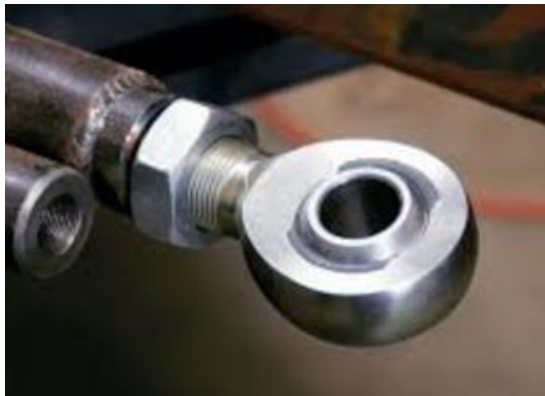
Contra-porca sem Positive Locking em Rod-End : Não permitida como fixação primária em ambos os lados
