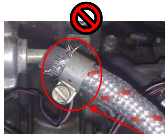
Uso proibido de abraçadeira em uma mangueira trançada de metal.
