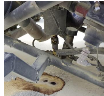
2018: Incêndio causado pela proximidade e falta de isolamento do escapamento com a linha de combustível*
