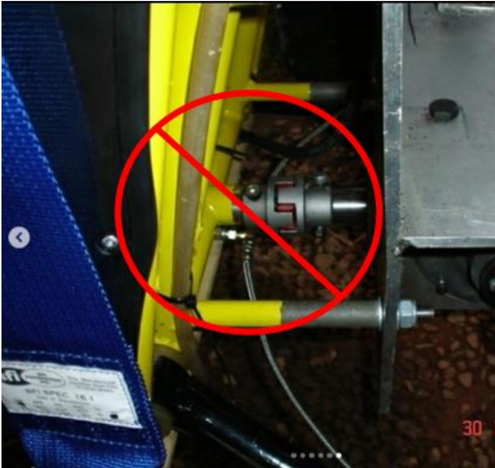
Figura 5 - Elementos de transmissão seccionando os membros da gaiola: inaceitável
