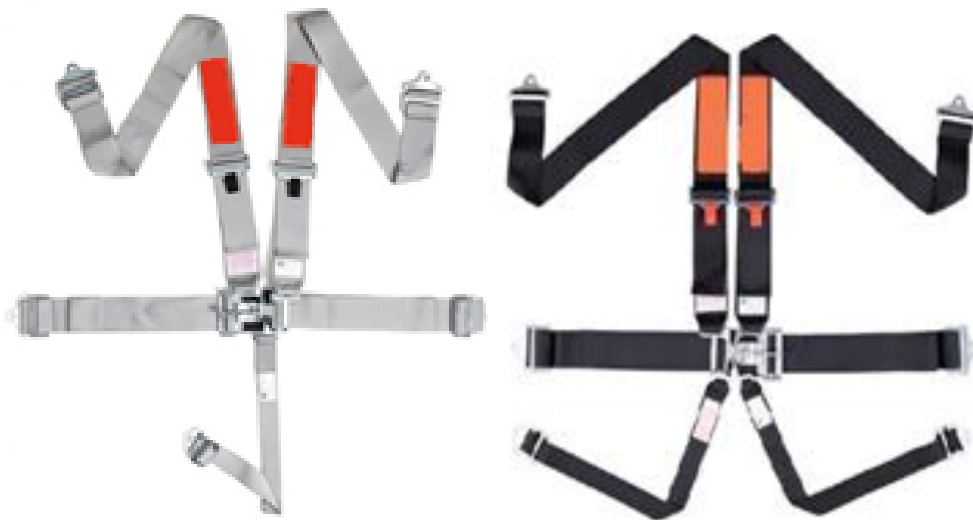
Figura 9 - Exemplos de cinto de 5 pontos (tira antissubmarina única) e cinto de 6 pontos (tira antissubmarina dupla)
