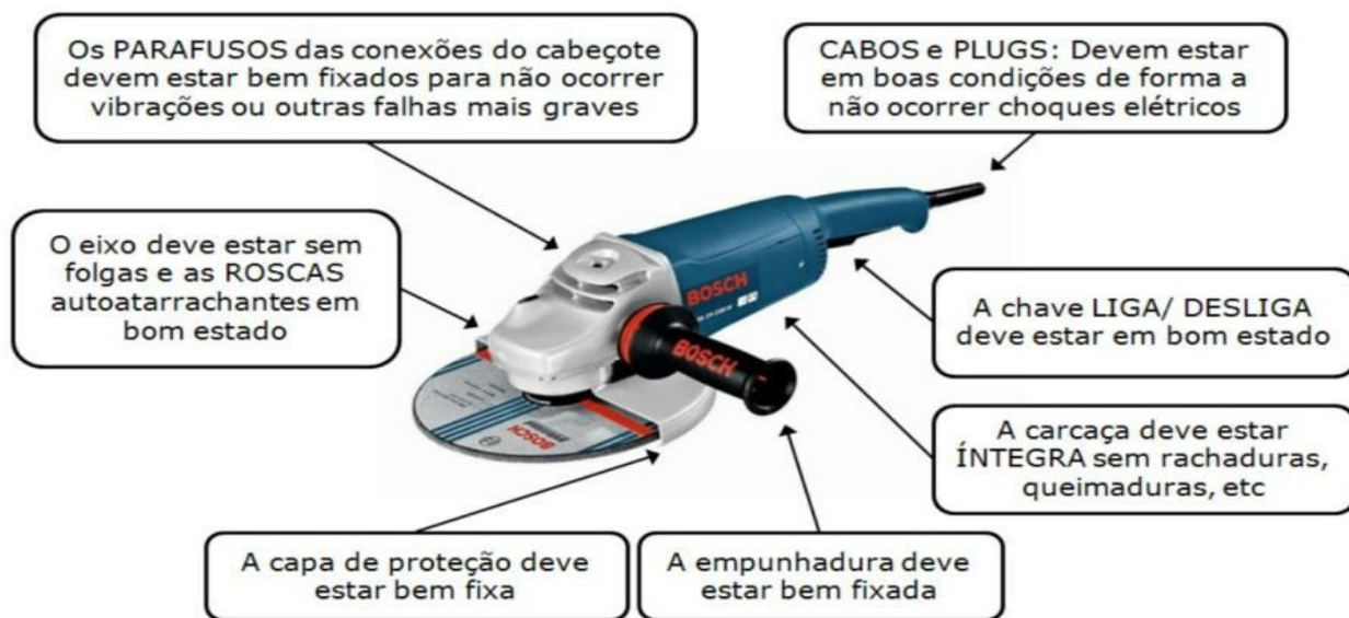
Figura C-3 – Esmerilhadeira com os requisitos de funcionamento
