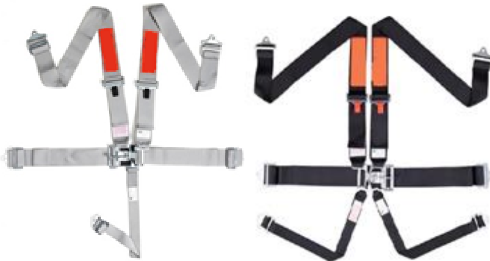
Figura 11 - Exemplos de cinto de 5 pontos (tira antissubmarina única) e cinto de 6 pontos (tira antissubmarina dupla)
