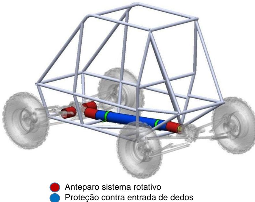
**Figura 4 - Proteções dos sistemas rotativos no cockpit**
